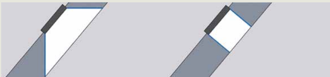
Schematische Darstellung der Montageanleitung des Herstellers. Dem Verarbeiter stehen je nach baulicher Gegebenheit unterschiedliche Einbauvarianten zur Verfügung. Links ist die optimale Lösung mit maximalem Lichteinfall und Kopffreiheit abgebildet. Rechts die Variante mit rechtwinklig zum Fenster verbauter Innenbekleidung.
